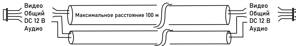
Рис. 9 Комбинированный видеокабель для подключения видеодомофона
