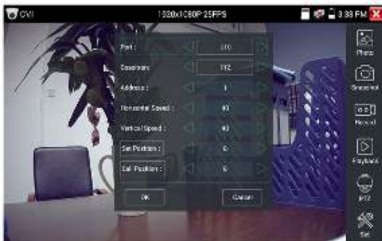
Рис. 75 Настройки для управления PTZ CVI видеокамерой по коаксиальному кабелю
