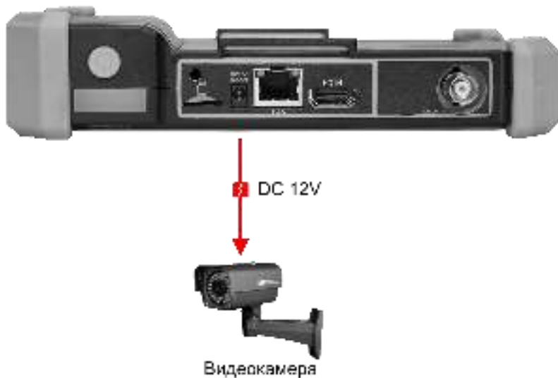
Рис. 8 Подключение питания к IP-видеокамере
