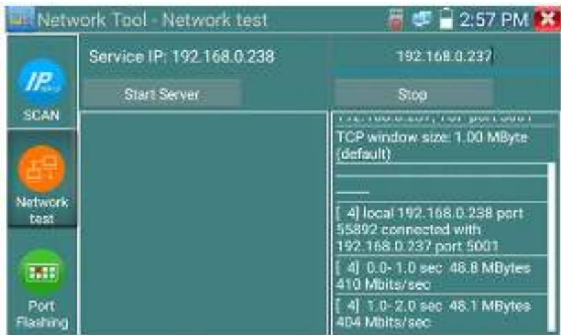
Рис. 91 Работа 2го тестера в режиме «клиент» при проверки пропускной способности сети
