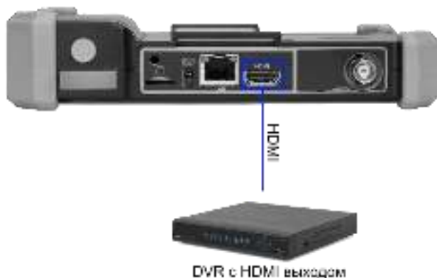
Рис. 10 Подключение HDMI устройств к тестеру.
