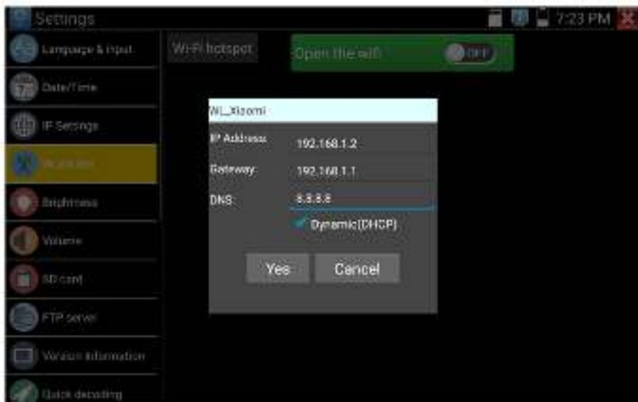
Рис. 130 Присвоение статического IP и тд. для выбранной беспроводной сети
