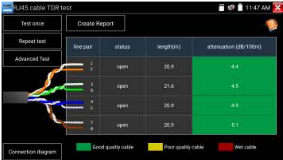
Рис. 102 Интерфейс рефлектометра (TDR) для кабеля «витой пары»
