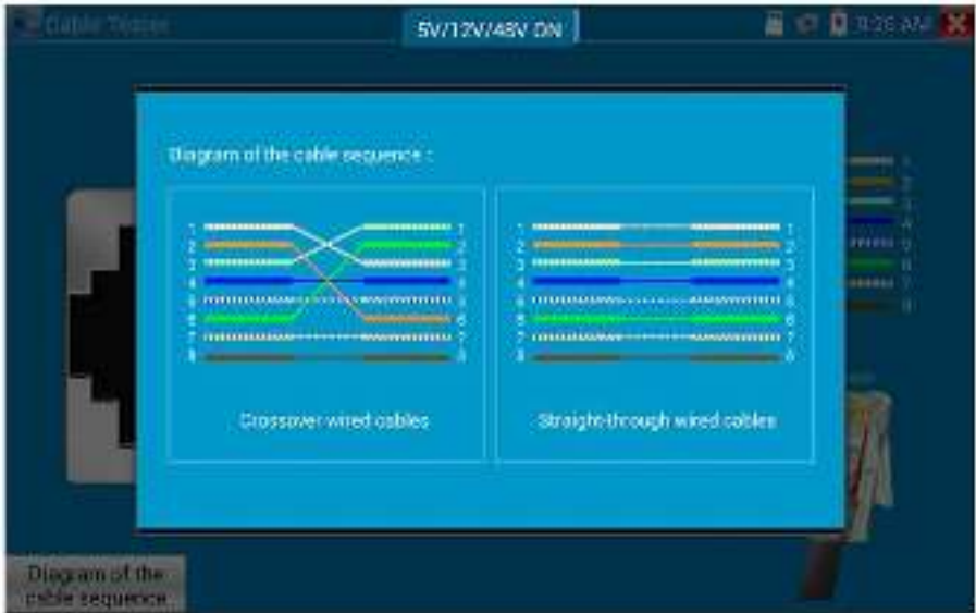
Рис. 101 Диаграммы обжимки разными методами кабеля «витой пары»
