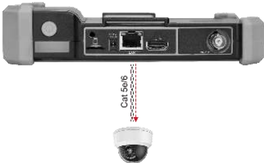
Рис. 6 Подключение IP-видеокамеры к тестеру
