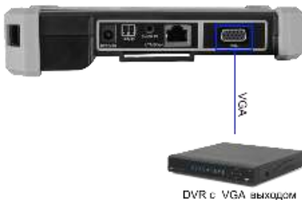
Рис. 11 Подключение VGA устройств к тестеру.
