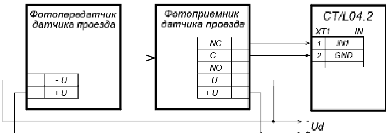
Рисунок 8. Схема подключения датчиков проезда
