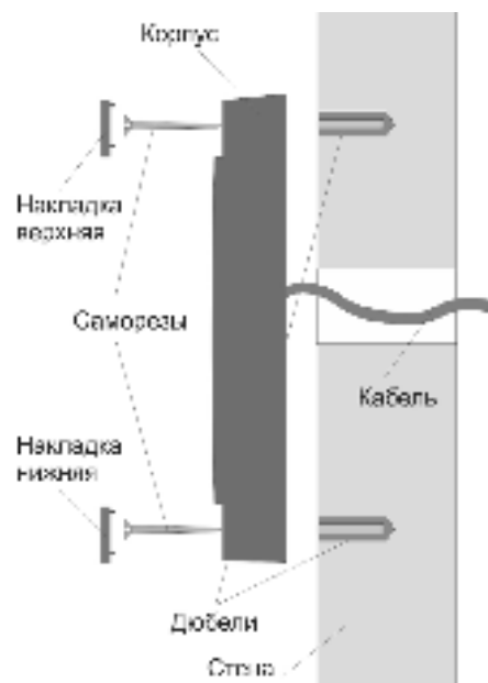
Рисунок 4. Крепление считывателя PNR- EH19
