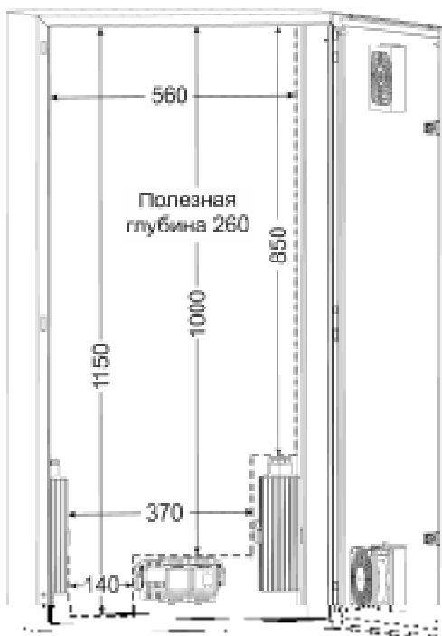
Рисунок 1 – Пространство внутри для установки доп. оборудования
